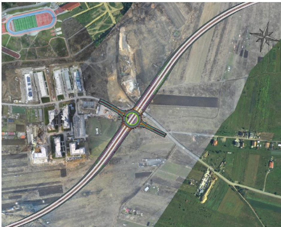
Fig. 9 – Nod 14 – Plan situatie - alcatuire geometrica
