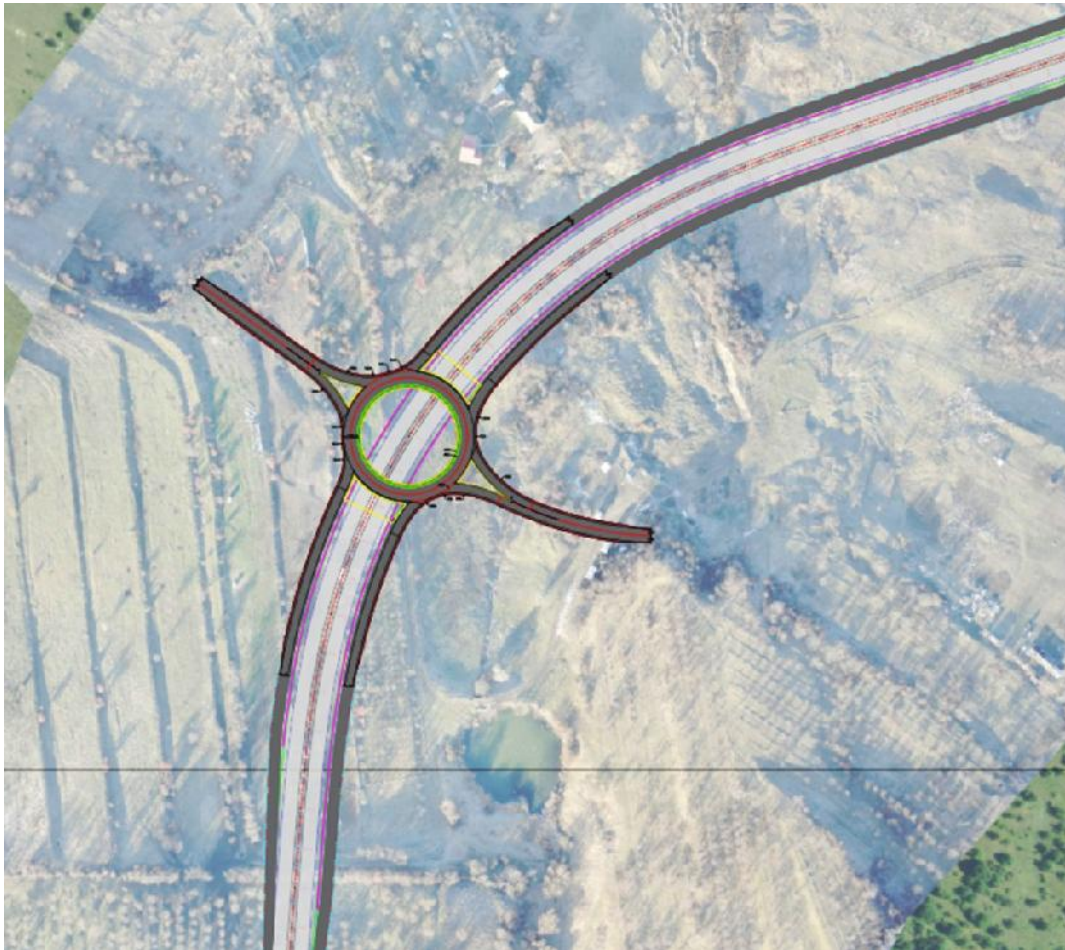
Fig. 5 – Nod 12 – Plan situatie - alcatuire geometrica
